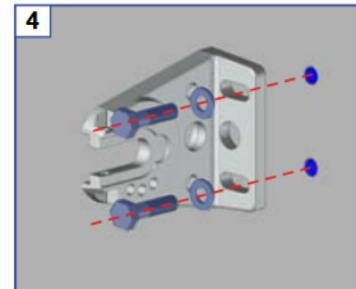
Fixation avec des vis Ø10mm. Kit de vis, cheville et rondelle non fournis.
