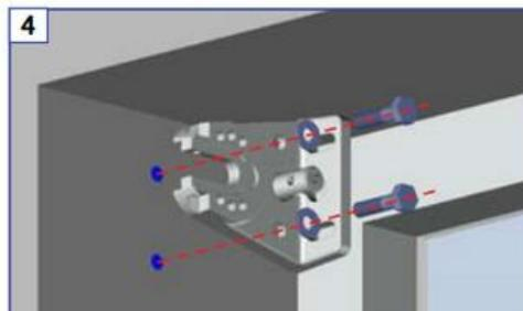
Fixation avec des vis Ø10mm. Kit de vis, cheville et rondelle non fournis.
